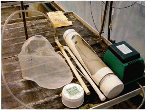
Équipement de fermenteur à thé de compost de la compagnie Bob's Compost Tea Brewers utilisé à l'ITA St-Hyacinthe.
